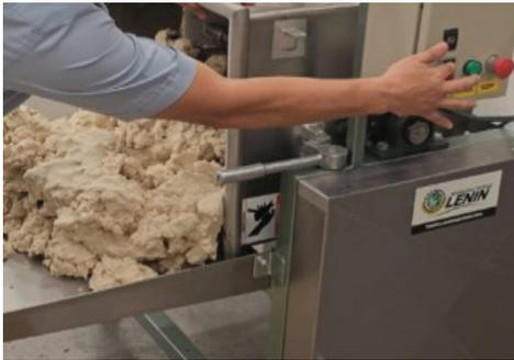
**15** Si se acciona el botón motor chasis, la revolvedora no funcionará hasta tener contacto con el microswitch
