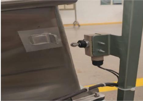
**13** Al no tener contacto el bote con el microswitch la revolvedora se apagará.
