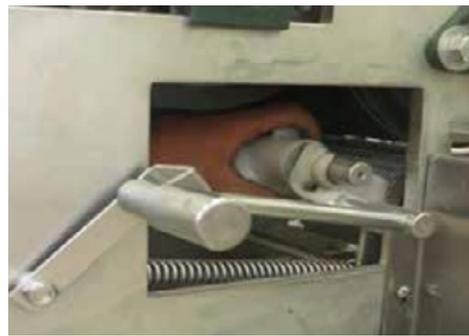
**24** Verificar que el cortador esté correctamente ensamblado
