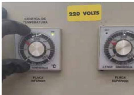
**15** Girar pirómetro superior en la posición de 140°C e inferior a 160°C
