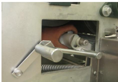
**23** Colocar cortador en la base, verificar que esté correctamente instalado y asegurado.
