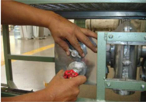
**5** | Verificar que la llave carburadora esté en 0 y abrir llave de paso de gas a válvula carburadora
