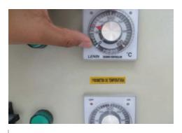
Ajuste el pirómetro superior a 140°C girando en el sentido del reloj
