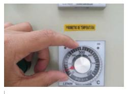
Ajuste el pirómetro inferior a 50°C girando en el sentido del reloj
