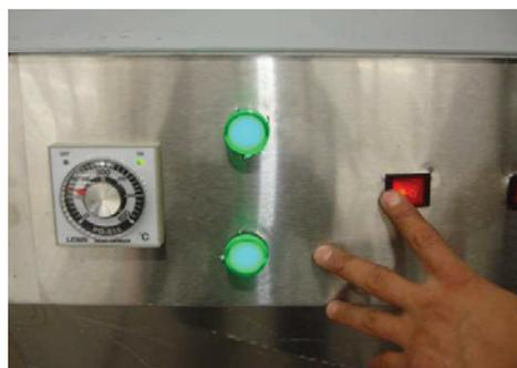
**2** Encender switch de pirómetro (izquierda)
