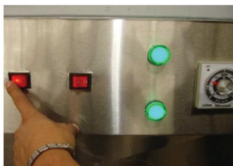
**4** Encender switch de pirómetro (derecha)
