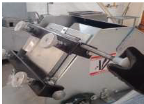
J Colocar varilla para asegurar placa
