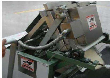
**13** Abrir las placas girando la palanca nuevamente verificando que la tortilla se deslice libremente.
