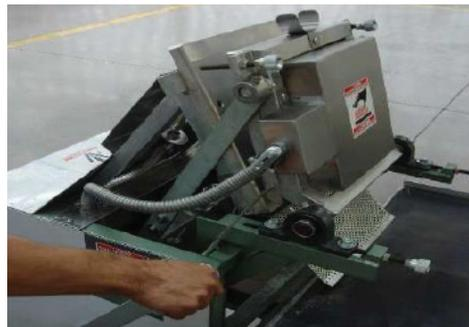
**11** Abrir las placas girando la palanca a las derecha para que la masa caiga.
