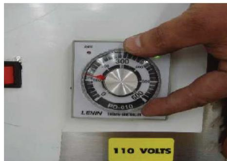
**5** Girar pirómetro de placa inferior a 140°C, se encenderá foco piloto y se apagará al llegar a la temperatura asignada.
