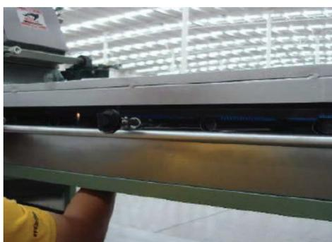
**8** Encender quemador tipo H del comal y regular flama con válvula de gas.
