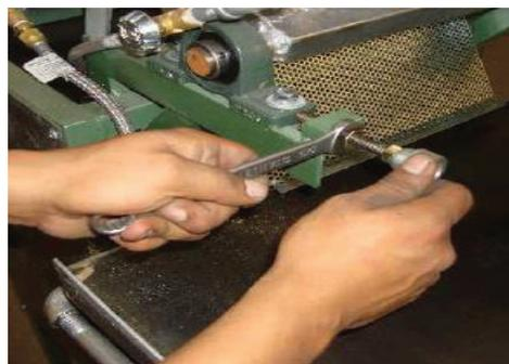
**14** Ajuste grosor de tortilla si es necesario. Girar perillas de ajuste inferiores.
