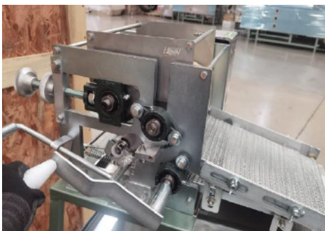
9 Girar palanca de transmisión del cabezal
