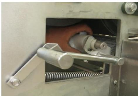
**7** Colocar cortador en la base, verificar que está correctamente instalado y asegurado
