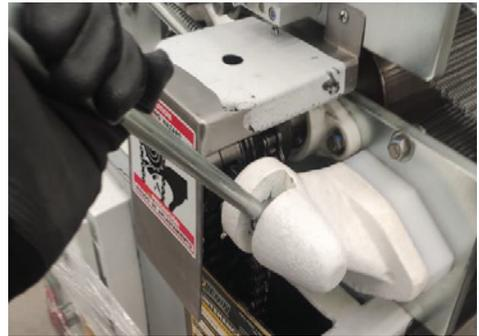
**10** | Subir palanca de clutch para accionar rodillos del cabezal.
