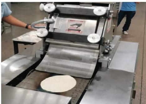
**27** Verificar forma y grosor de la tortilla después de ser prensado el testal.
