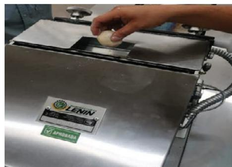
**26** Colocar testal en ranura de lámina superior de la prensa.
