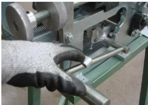
**1** Asegurar la palanca del cortador.
