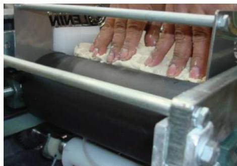
**4** Agregar aproximadamente medio kilo de masa a los rodillos (no demasiada para que se mantenga adherida la cortina de masa)
