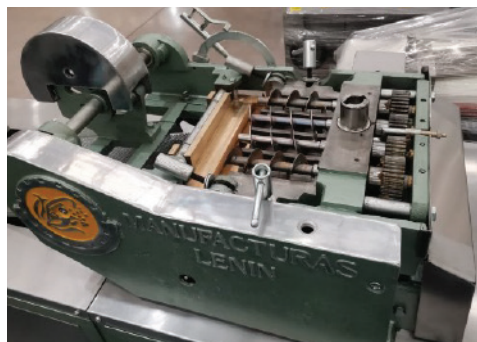
15 Verificar el correcto funcionamiento del cabezal. Cadenas y piezas móviles.
